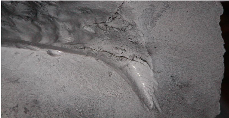
Fig. 1. Falla original del swing-lever. Revelación por partículas magnéticas. Fuente: SIE/INDESA
